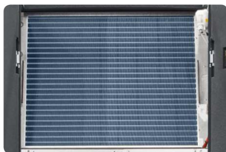
Todos los modelos de la gama **JREF DX** incorporan de serie baterías de intercambio térmico con **tratamiento hidrofílico**. La presencia del recubrimiento particular, junto con una elección adecuada de la velocidad de paso del flujo de aire, favorece la recogida de los condensados en el proceso de deshumidificación, evitando así el arrastre de gotas hacia el interior y exterior de la unidad.
